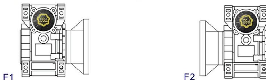
如没有特别说明,将按照如图F1和B3安装方位的组合样式供货。
